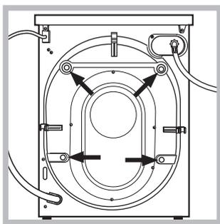
3. Quite los 4 tornillos de protección para el transporte y la arandela de goma con el correspondiente distanciador ubicados en la parte posterior (ver la figura).
